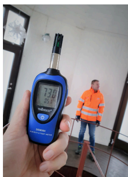
Fuktmätning med handinstrument
